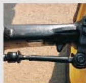
พวงมาลัยพาวเวอร์พร้อมเพลาล้อหน้ารองรับงานหนัก ทำงานได้มีประสิทธิภาพสูง ขับที่สะดวกสบาย
